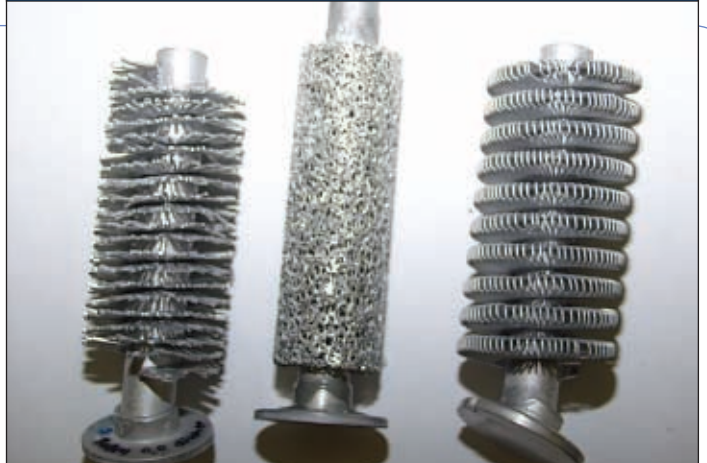
Abb 7: Wärmerohre für die PC-Kühlung
