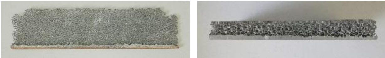
Bild 1: Metallschaumproben: Kupferplatte mit Aluminiumschaum verlötet (links) und Aluminiumplatte und Aluminiumschaum aus einem Guss (rechts) als Wärmeübertragerflächen.
