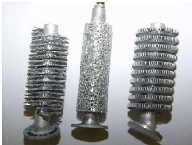
Bild 3: Konstruktionen von Wärmerohren; Links: Igelkonstruktion; Mitte: Metallschaumkonstruktion; Rechts: Bügelkonstruktion
